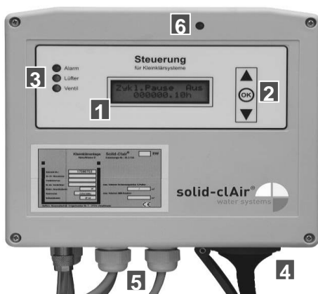
Abbildung 2: Bedien- und Anzeigeelemente der Platinensteuerung
